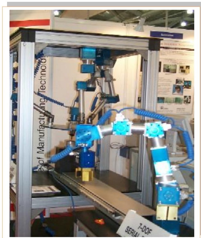
Slika 6.21: Primer modularnega robota - paralelni manipulator
