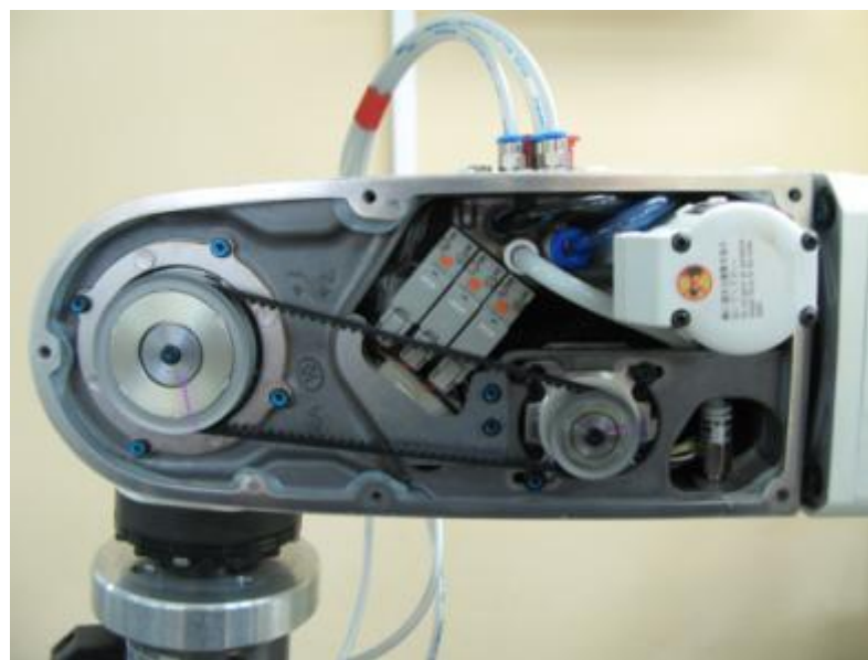
Slika 8.28: Servopogon robota z zobatim jermenom
