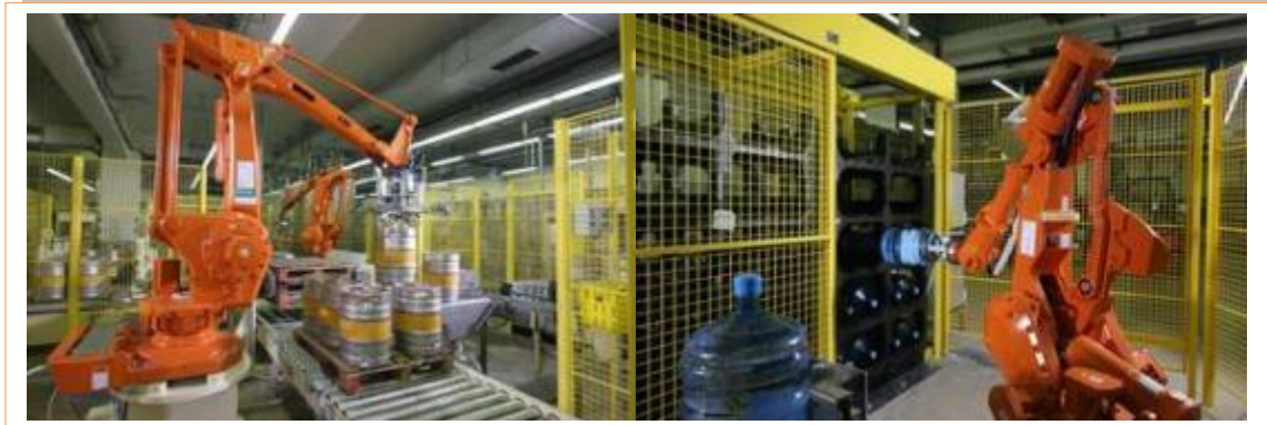
Slika 7.6: Paletizacija in depaletizacija sodčkov
