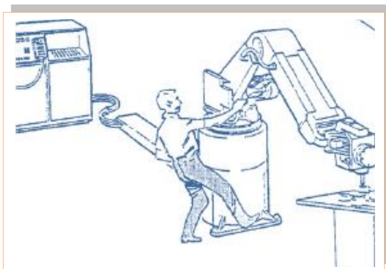
Slika 13.1: Nevarnost stiska pri delu z roboti
