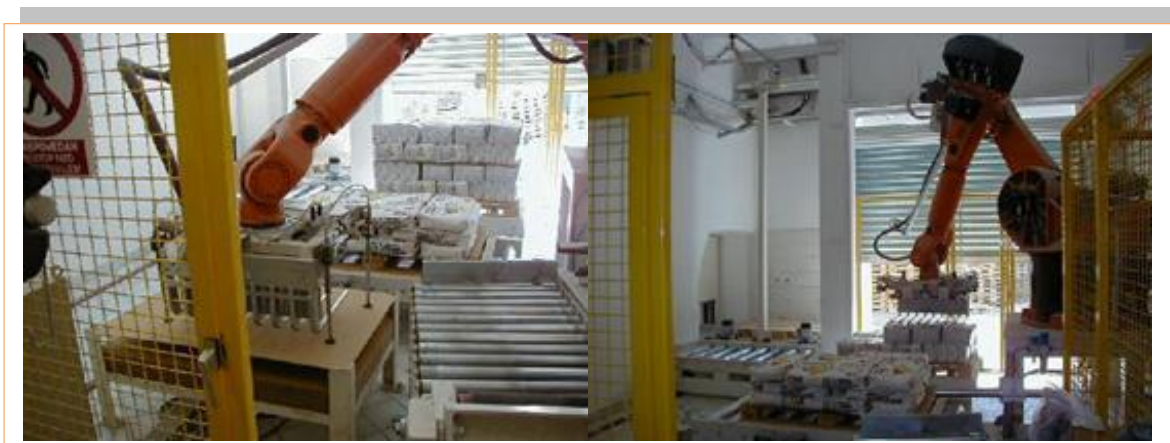
Slika 7.5: Avtomatizirano zlaganje vreč na palete v JUB-u (Pakman)
