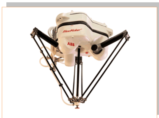
Slika 6.18: Primer paralelnega robota
