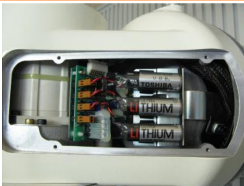
Slika 8.24: Baterije v namen ohranitve položaja v primeru izpada električne energije
