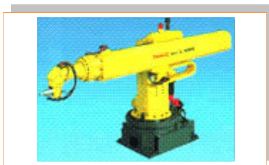
Slika 6.9: Primer sferičnega robota
