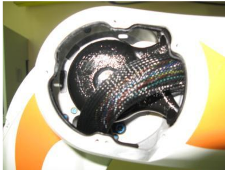
Slika 8.27: Servopogon robota s harmonskim gonilom
