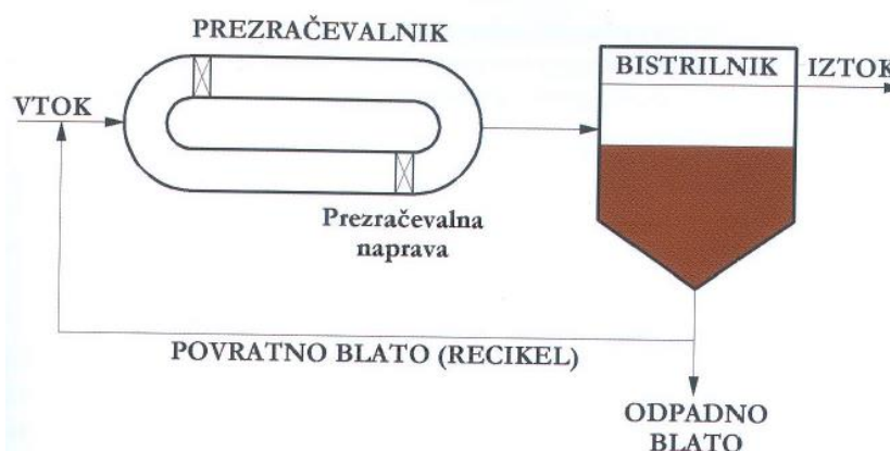
Slika 47: Shema oksidacijskega jarka
