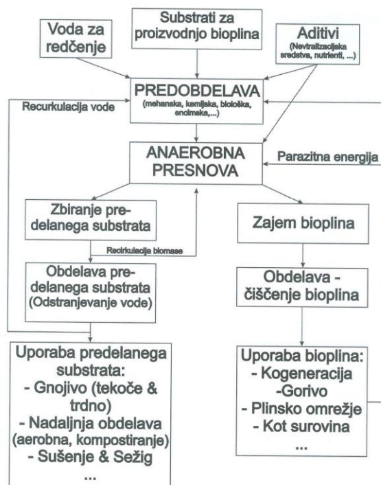
Slika 39: Shema tehnologije anaerobnega procesa
