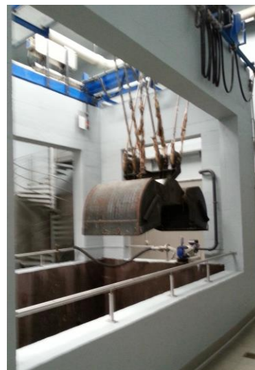
Slika 55: Grabilec kamenja v prvem objektu mehanskega čiščenja
