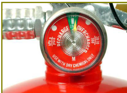
Slika 155: Primer tlačnega manometra na ročnem gasilniku Vir: www.sos112.si/slo/tdocs/pozar_gradivo.pdf (16.1.2010)
