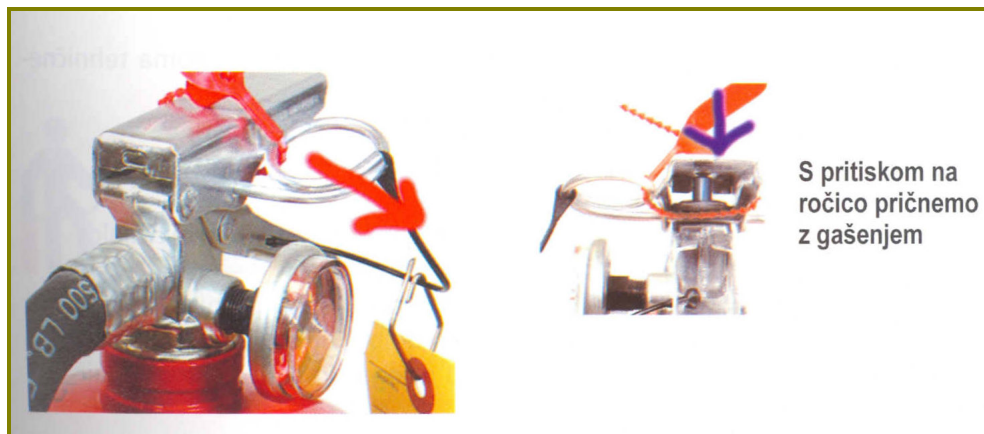
Slika 160: Način aktiviranja gasilnika s prahom pod stalnim tlakom
